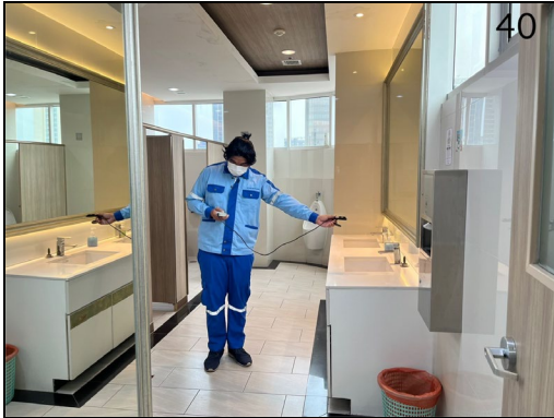
การตรวจวัดคุณภาพความเข้มของแสงในสถานประกอบการ บริเวณห้องน้ำชาย (ชั้น 15)
