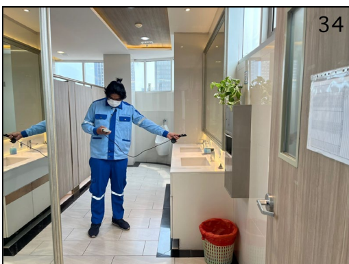
การตรวจวัดคุณภาพความเข้มของแสงในสถานประกอบการ บริเวณห้องน้ำชาย (ชั้น 16)
