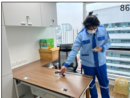
การตรวจวัดคุณภาพความเข้มของแสงในสถานประกอบการ จุดห้องพักรักอาจารย์ ห้อง 40 (ชั้น 15)
