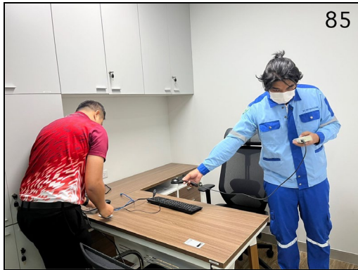
การตรวจวัดคุณภาพความเข้มของแสงในสถานประกอบการ จุดห้องพักรักอาจารย์ ห้อง 31 (ชั้น 15)
