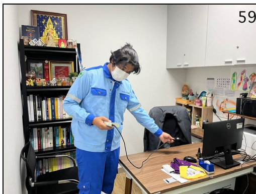
การตรวจวัดคุณภาพความเข้มของแสงในสถานประกอบการ จุดห้องพักอาจารย์ คุณภูธิป (ชั้น 15)
