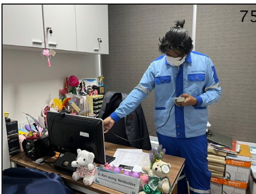
การตรวจวัดคุณภาพความเข้มของแสงในสถานประกอบการ จุดห้องพักอาจารย์ คุณนาฏอนงค์ (ชั้น 15)
