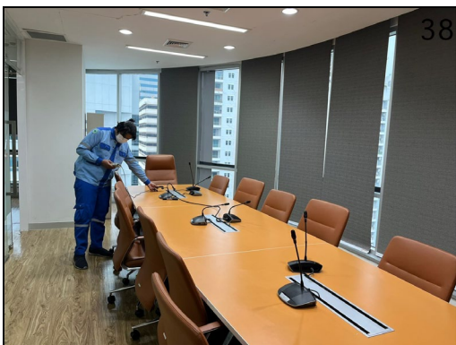
การตรวจวัดคุณภาพความเข้มของแสงในสถานประกอบการ บริเวณห้องประชุม (ชั้น 15)
